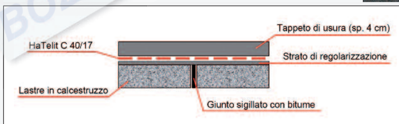
Figura 4 - La sezione tipo dell'intervento di ripristino con la griglia HaTelit®
