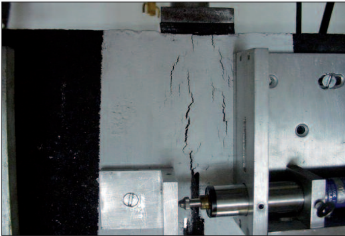
Figura 3 - Un campione rinforzato con HaTelit® dopo 490.000 cicli di carico
