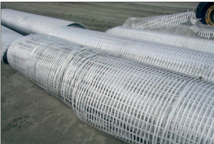
Bild 8. Unsachgemäße Lagerung von Geokunststoffen: über längere Zeit sollen Geokunststoffe vor freier Bewitterung geschützt gelagert werden
