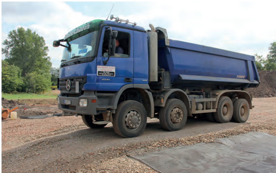
Abb. 12: Feldversuch zur Bestimmung der Einbaubeschädigung nach Überfahung mit schweren Erdbaugeräten, Projekt Frose – Nachterstedt
