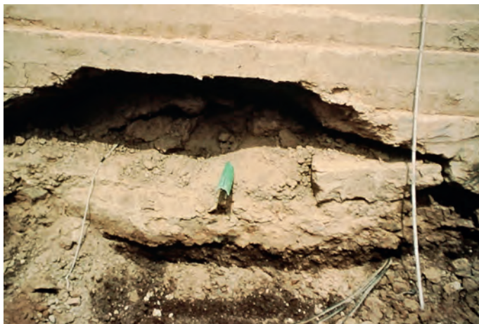
Abb. 5: Großversuch zur Verifizierung einer Erdfallsicherung auf Grundlage eines Gewölbemodells, NBS Knoten Gröbers
